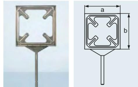
Stativ-Plattenhalter für Glaskeramikplatten. Aus temperaturbeständigem Chrom-Nickelstahl.
